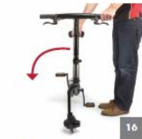
16 Girare i pedali portandoli alla posizione indicata (pedale destro in alto), quindi adagiare la Gocycle sul pavimento
