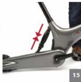
15 Continuare ad abbassare la Gocycle fino al completo inserimento del Lockshock.
