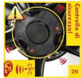
20 Assicurarsi che le leve a camme siano chiuse (si avverrà uno scatto alla chiusura di ciascuna leva)
