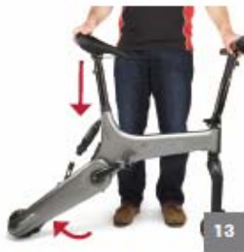
13 Abbassare la Gocycle delicatamente per consentire alla trasmissione Cleandrive di continuare a ruotare all'indietro.
