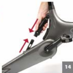
14 Allineare il corpo del Lockshock™ al pistone come mostrato in figura
