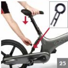
25 Portare la Gocycle in posizione eretta, quindi spingere la sella verso il basso e inserire il perno del Lockshock come mostrato in figura
