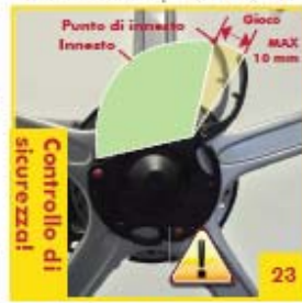
23 Aprire e chiudere tutte le leve a camme per verificare che la regolazione e il funzionamento corrispondano a quanto illustrato in figura. Consultare il Manuale utente per informazioni su come regolare le leve. NON utilizzare la bicicletta in nessuna circostanza in presenza di leve allentate o qualora la chiusura o apertura non risulti uniforme per tutte le camme.
