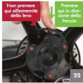
22 Chiudere le leve a camme come mostrato in figura
