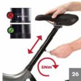
26 Impostare la sella all'altezza desiderata. Sembrare la fascetta a 5 Nm. (Montare il reggisella inserendolo ALMENO fino al contrassegno di inserimento minimo)
