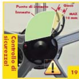
19 Aprire e chiudere tutte le leve a camme per verificare che la regolazione e il funzionamento corrispondano a quanto illustrato in figura. Consultare il Manuale utente per informazioni su come regolare le leve. NON utilizzare la bicicletta in nessuna circostanza in presenza di leve allentate o qualora la chiusura o apertura non risulti uniforme per tutte le camme.
