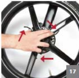
17 Mantenendo le tre leve a camme completamente aperte, montare la ruota al mozzo anteriore
