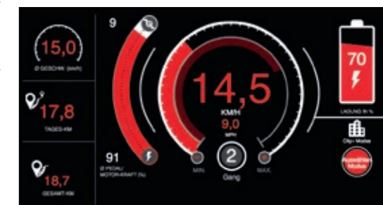
Kommandozone Bei aktiver Bluetooth-Verbindung wird das Smartphone per App zum digitalen Cockpit
